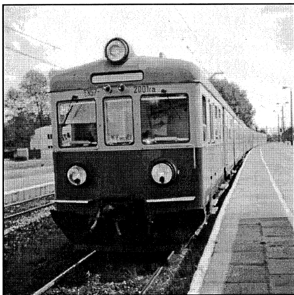
Fot. 1. Zespół EN57-2001 z układem rozruchu impulsowego w czasie jazdy z zespołem EN57-1462 o rozruchu klasycznym (24.08.1994 r.)
