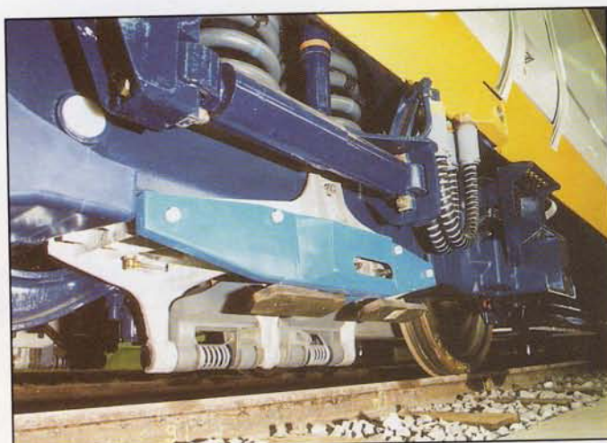
Wagon silnikowy z odbierakiem z trzeciej szyny
